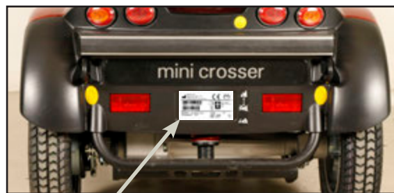
Plaatsing van serienummerplaatje op voertuig.
