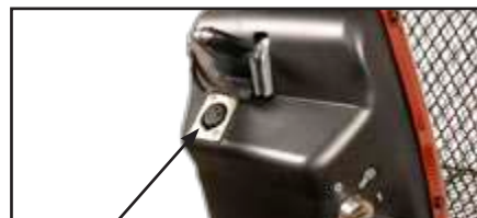
Doe de stekker in het 3-polige laadpunt op de stuurkolom. De aansluiting bevindt zich onder de rubberen beschermkap.
